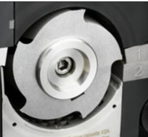
Прогрессивная геометрия резки между ротором и неподвижными ножами обеспечивает быстрое измельчение и надежную защиту от закупоривания.
