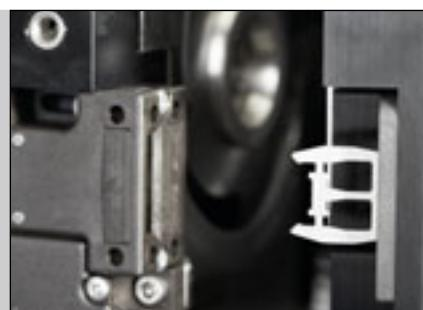
Закрывается особенно надежно: стопорная защелка камеры измельчения.
