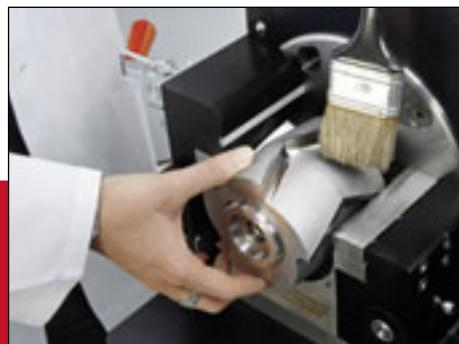
Ротор в открытых для очистки режущих мельницах FRITSCH легко проворачивается рукой и извлекается без использования инструментов.
