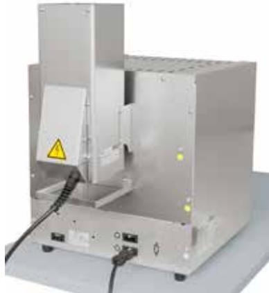
Стандартная лабораторная муфельная печь L 5/11 с катализатором KAT 50 см.
