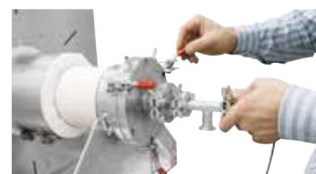
Конечные фланцы с водяным охлаждением с быстросоединяющими соединительными вставками в качестве дополнительного оснащения
