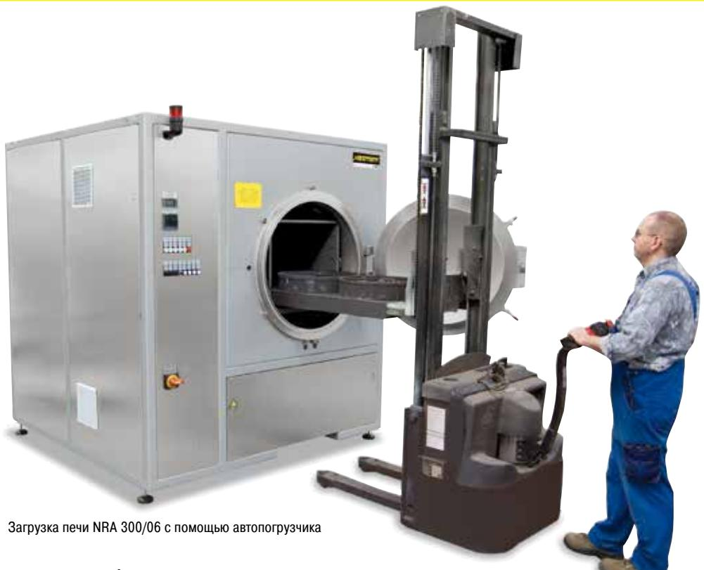
Загрузка печи NRA 300/06 с помощью автопогрузчика
