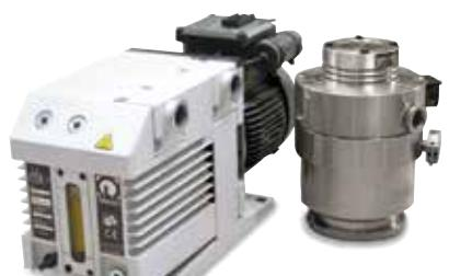
Насосный стенд с турбомолекулярным насосом и форвакуумным насосом для тепловой обработки в вакууме до 10⁻⁵ мбар
