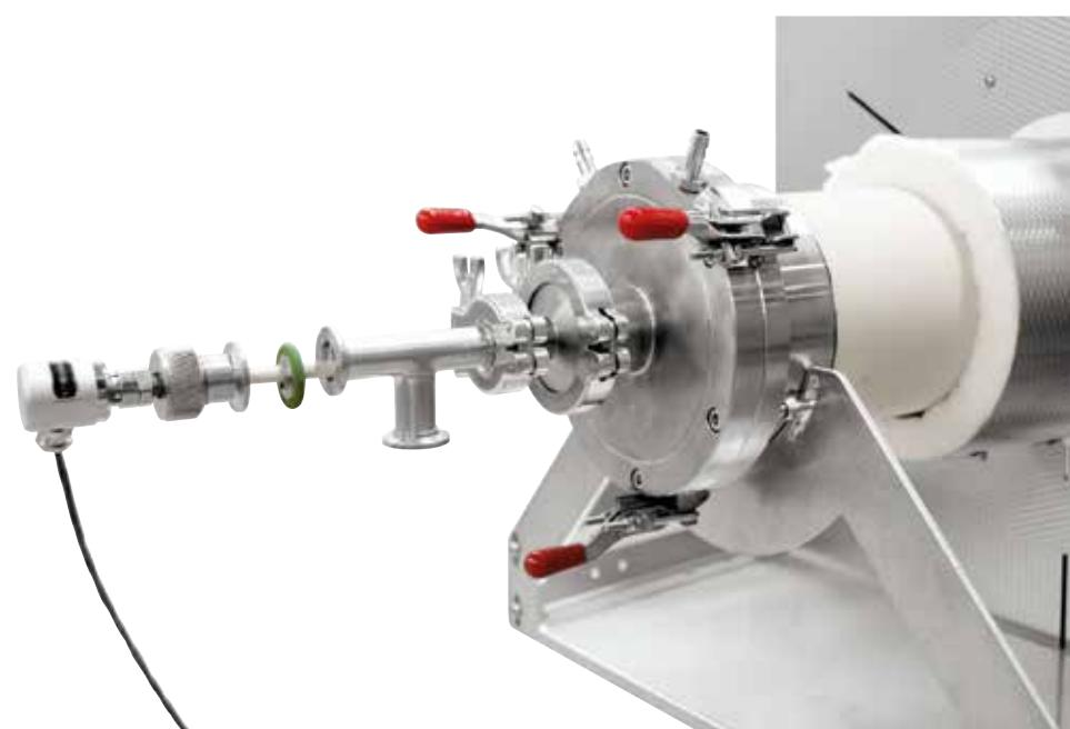
Термоэлемент для регулировки садки в печи RHTH 120/600/18
