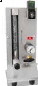
Газационная система для негорючего защитного или реакционного газа
