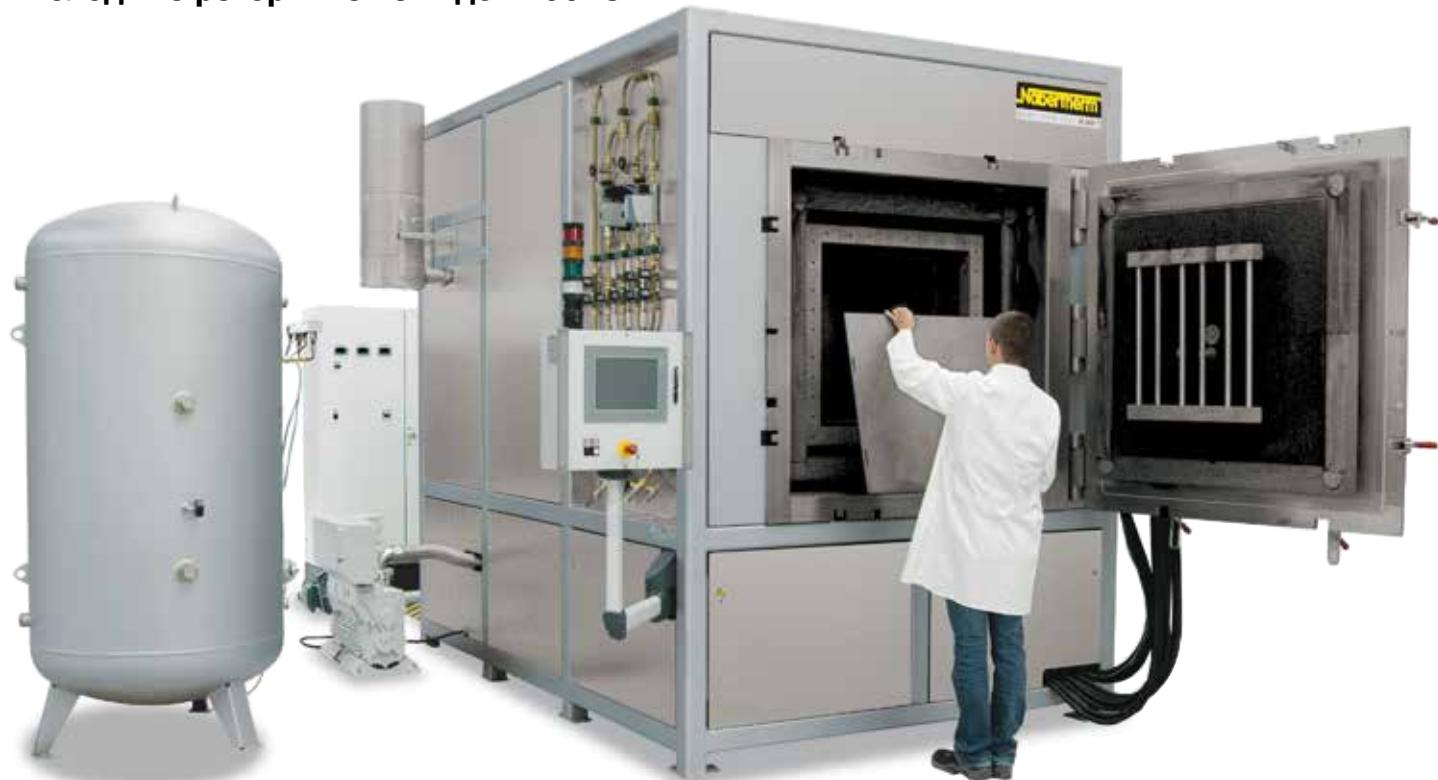
VHT 500/22-GR H<sub>2</sub> с технологическим загрузочным бункером из ХВУ для работы с водородом
