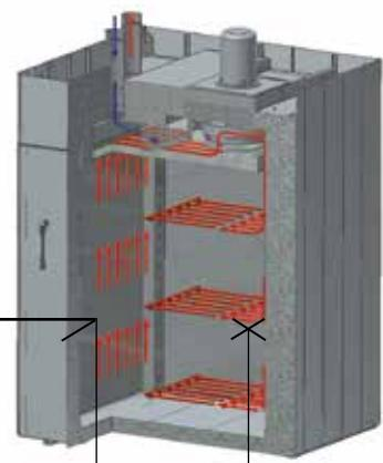
Точность системы определяется путем суммирования допусков контроллера, термоэлемента и полезного пространства
