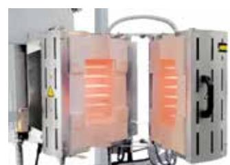
RS 100/250/11S в откидном исполнении для встраивания в испытательное устройство
