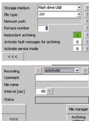
NTLog Comfort для записи данных системы управления ПЛК Siemens
