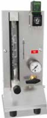
Газационная система для негорючего защитного или реакционного газа, с запорным краном и расходомером с регулирующим вентилем, с готовой к подключению системой трубопроводов
