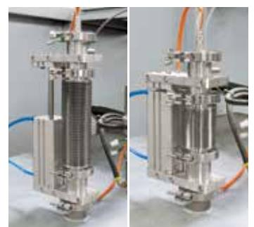
Термоэлемент типа S с автоматическим устройством выдвижения для точного управления в нижнем диапазоне температур
