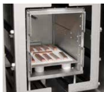
Тепловая обработка медных стержней в водороде в печи VHT 8/16-MO
