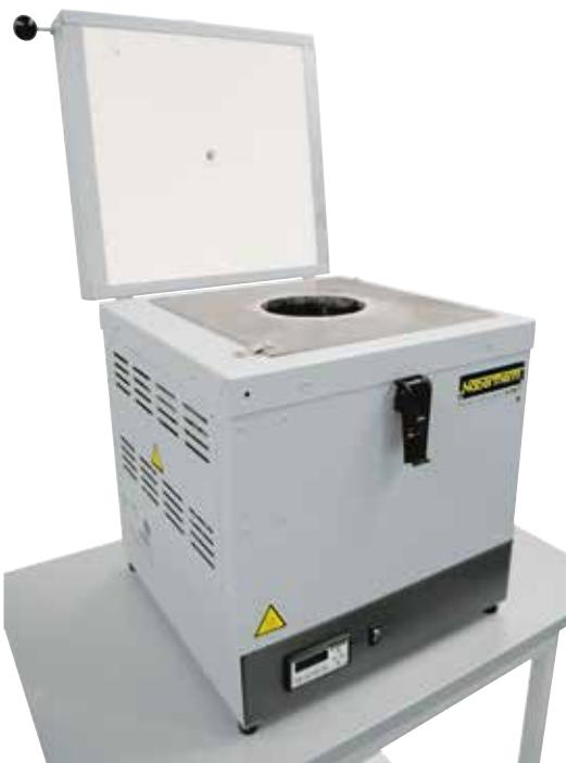
**K 2/10** в качестве стационарной тигельной печи с ручным вычерпыванием расплава со стальным тигелем для плавления свинца
