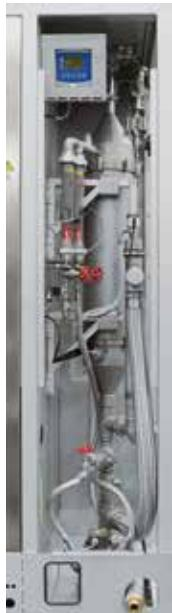
Система очистки технологических газов методом промывки
