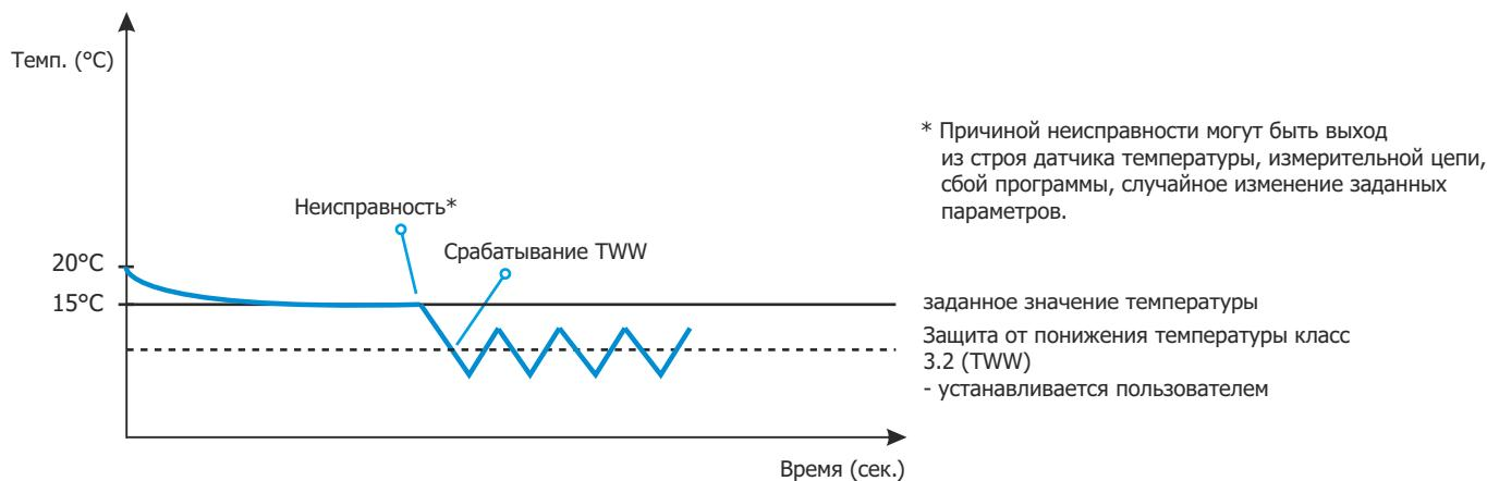
Защита от понижения температуры класса 3.2 по DIN 12880 стандартно устанавливается в модели CHL исполнения PREM TOP+, опционально – в модели CHL исполнений BASIC, COMF, PREM; ZL COMF и PREM.
