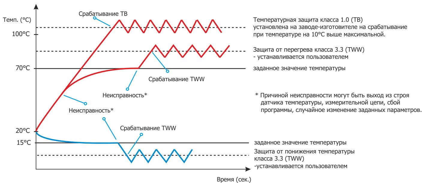
Защита от перегрева/понижения температуры класса 3.3 по DIN 12880 стандартно устанавливается в изделиях KK, ST PREM TOP+ и IL в исполнении TOP+. Опционально доступно для моделей ST BASIC, COMF, PREM и IL в исполнении STD. Код заказа: \*/3.3 (опция устанавливается на заводе-изготовителе).
