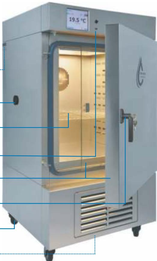
Климатические камеры оснащены микропроцессорным PID-контроллером температуры и влажности ( дополнительно — освещенности, опция — \*/FIT) с большим (5,7") полноцветным сенсорным экраном, интуитивно понятным меню и удобным программным обеспечением. Одним из важнейших преимуществ является возможность подключения к сети Ethernet для удаленного управления с любого компьютера. Климатические камеры поставляются исключительно в исполнении TOP+.
