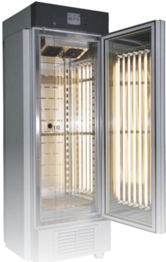
Климатические камеры с фитотронной системой позволяют поддерживать стабильные условия окружающей среды с контролем температуры, влажности и освещенности.
